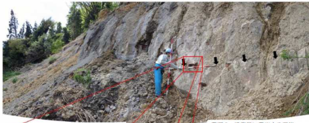
露頭 5 滑落崖に露出する泥岩
