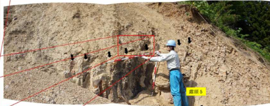
露頭 5 滑落崖に露出する泥岩
