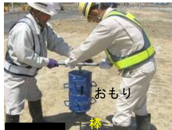
図2 スウェーデン式 サウンディング調査
